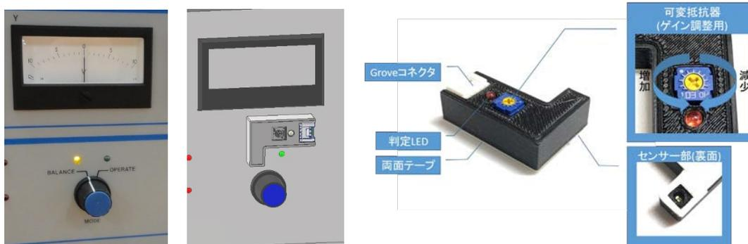
図 2.光センサ(左：BALANCE LED、中：取付イメージ、右：光センサ)
