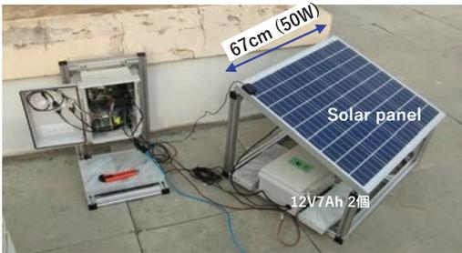
太陽光発電パネルを電源として用いる場合には、計測器の消費電力を小さくする必要があります。余計な機能を取り去り、蓄電池を大きくすることにより24時間365日の運転に成功している。
