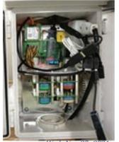
インドに32台配置している小型大気環境計測器（下段に4つ付いている丸いのがAlphasense社の電気化学センサ、PM2.5センサはこの奥にある）
