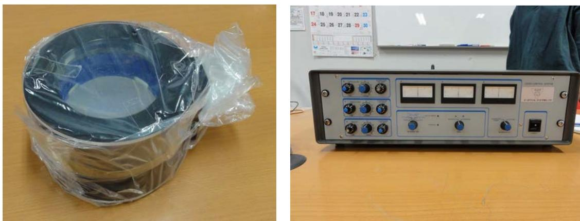
図 1. 左：エタロンフィルタ，右：専用コントローラ
