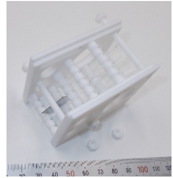
図14 分解洗浄可能な テフロン製スタンド形状
