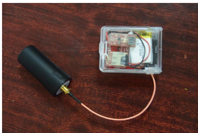
図13 低空研でのRTKキット組み上げ
