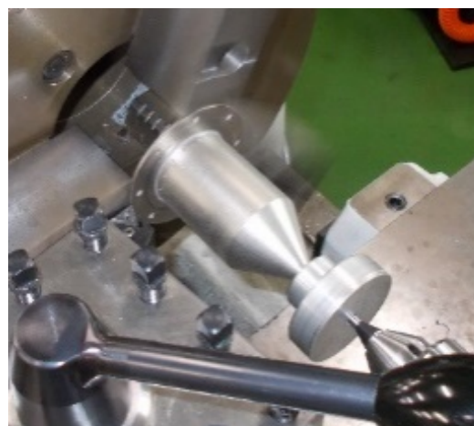
図4 3Dプリンタ製イオンエンジン用 ノズルの旋盤加工例
