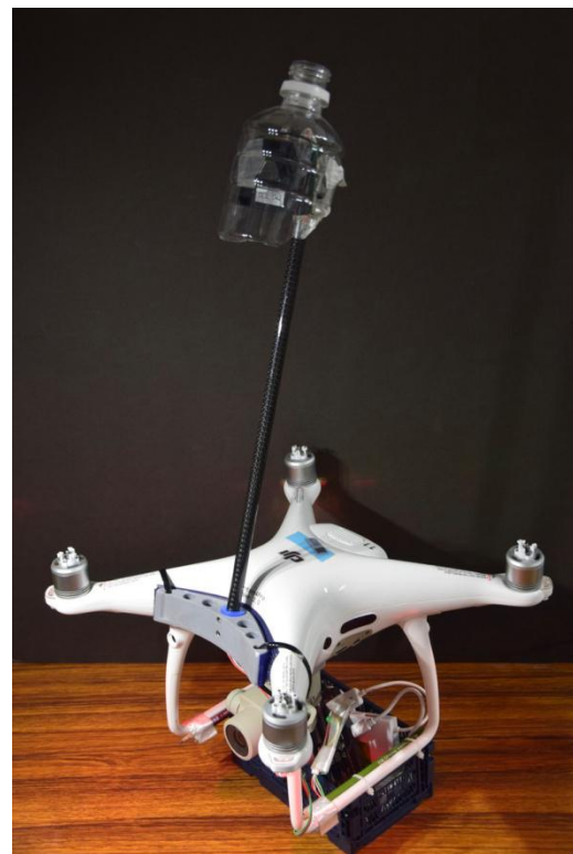
図5 塩ビからカーボンに材質変更した
