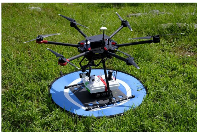
図8 ドローンにクローラーを搭載
