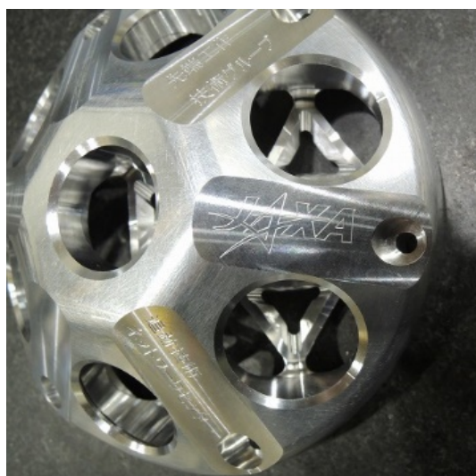
図5 レーザー測距用反射器 (Mt.FUJI)
