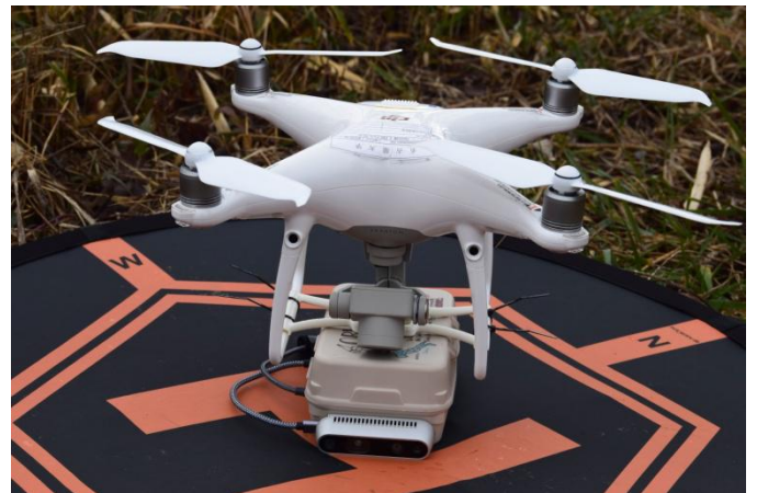
図10 ドローンに赤外線カメラを搭載
