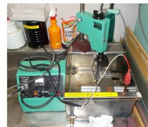
図4 タングステン板の穴あけ加工
