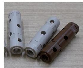
図 8-3 製作後の支柱 (右端がベスペル)
