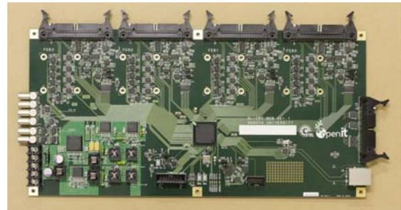
図 8. SciCRT バックエンドボード[4]
