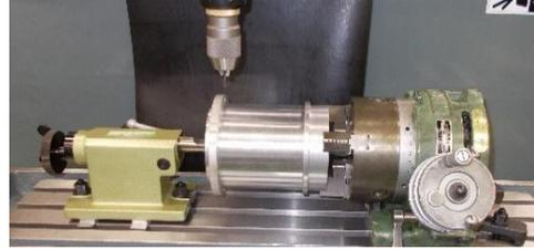
図 6-2 アルミパイプの穴あけ加工 (右側が割り出し盤)
