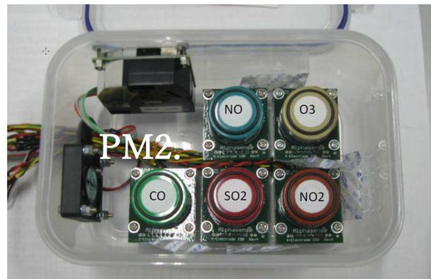
図6 製作した多種類の大气成分を観測できるマルチガスセンサ CO<sub>2</sub>: NDIR, PM2.5: Optical Scattering CO, NO, NO<sub>2</sub>, Ox, SO<sub>2</sub>: Electro-Chemical Sensor
