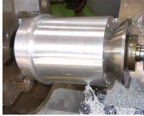
図 6-1 アルミパイプの旋削加工
