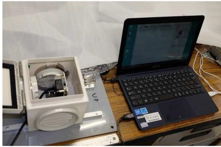
図2. 固定型の小型PM2.5計測装置。PM2.5センサを格納したBoxとノートパソコンからなる。
