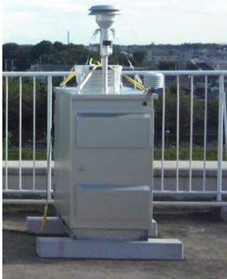
図3. 大型β線吸収装置と小型PM2.5計の同時測定比較実験の様子
