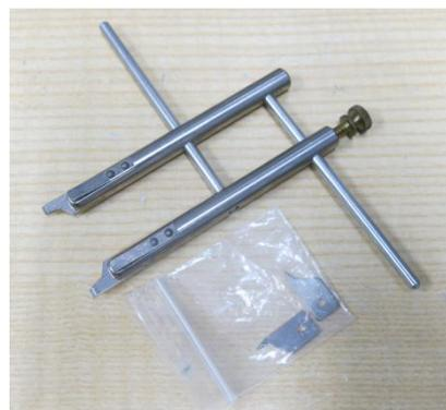
図12. ネジリングスパナ。レンズなどを固定しているネジリングの取付け取外しに使用する
