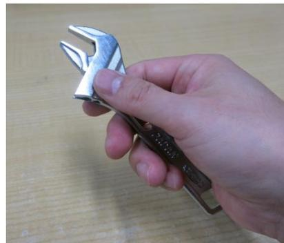
図 10. ハイブリッドモンキーレンチ (UM24)。薄く広く軽量で調整用ウォームネジの滑りもよく使いやすい。
