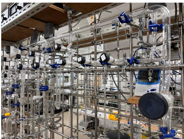
ガス精製用ガラス製真空ライン
