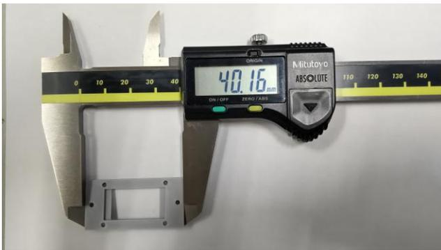
図16 外寸0.16mm大きい（設計では40mm）
