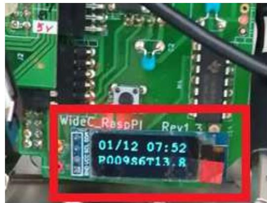
図2 増設基板上的の表示器
