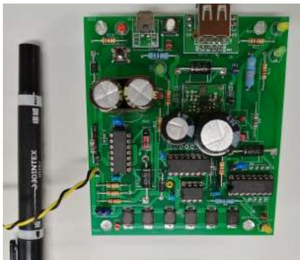
図 12 製作した「停電対策回路」
