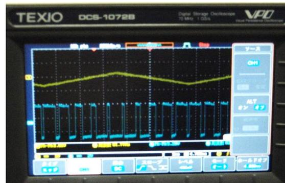
実習した回路の一例 : PWMモータ制御回路
